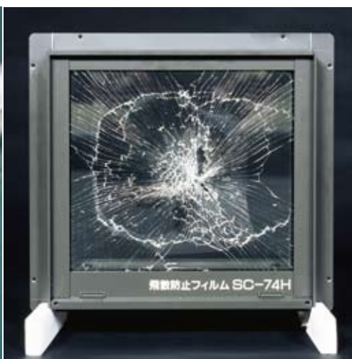
窓ガラスの飛散防止対策
